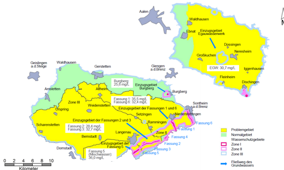
Abb. 1: Beispiel für aktuelles Nitratmonitoring in einer der Pilotregionen. Quelle: Zweckverband Landeswasserversorgung Baden-Württemberg
